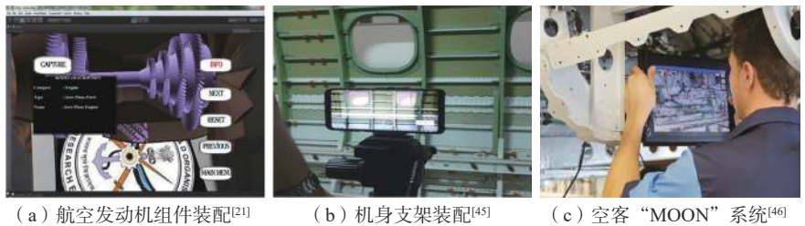
图 8 手持式 AR 装配技术在航空航天产品装配中的应用
